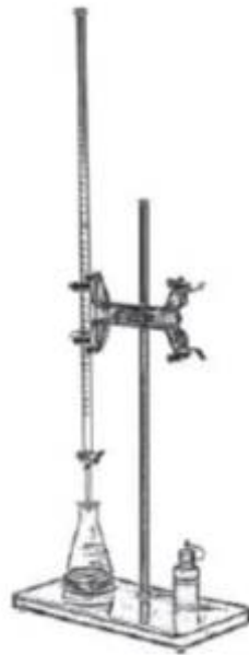
Gambar 2.2. Susunan alat titrasi (Sumber: Skoog 2014)
